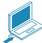
Inserte el termógrafo en el puerto USB de una computadora
